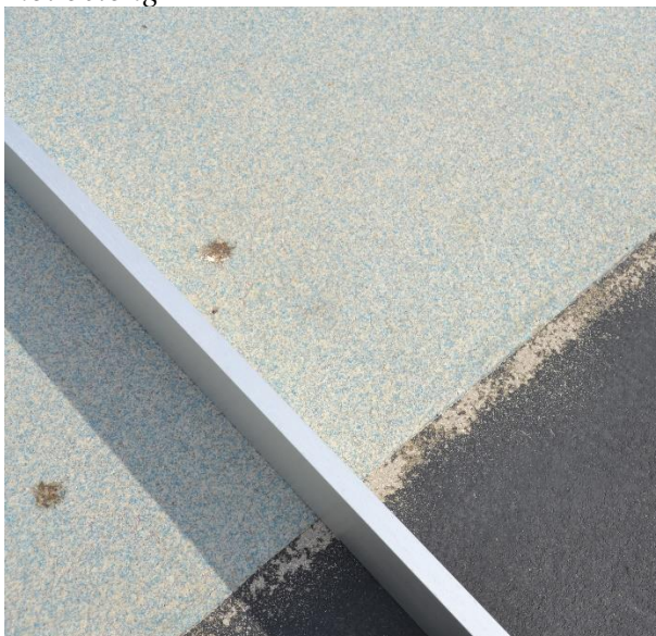
Figur 2.41 Visst slitage mot nästa provyta
