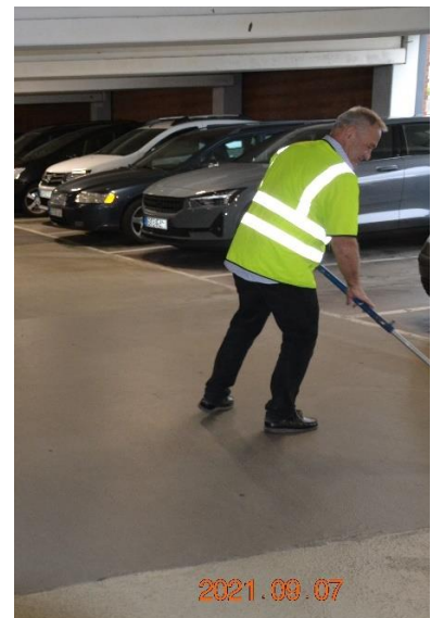
Figur 2.10 Ytligt slitage och indikationer på vidhäftningsläpp vid ”bomkartering” på Polyuretan StoCretec efter 8 år på parkeringsdäck i Kville
