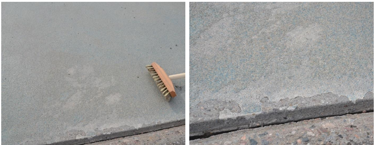
Figur 2.43 Akryl Silikal efter 6 år på parkeringsdäcket i Baggen 2021. Slitage genom topplacken och mot nästa provyta
