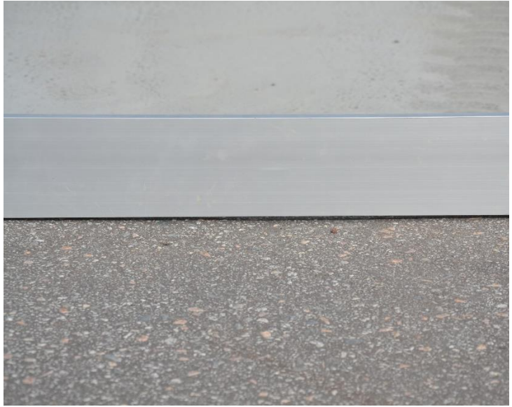
Figur 2.46 Bompartier registreras. Aningen spårbildning konstateras med hjälp av rätskiva
