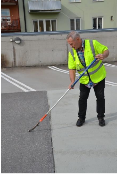
Figur 2.46 Bompartier registreras. Aningen spårbildning konstateras med hjälp av rätskiva
